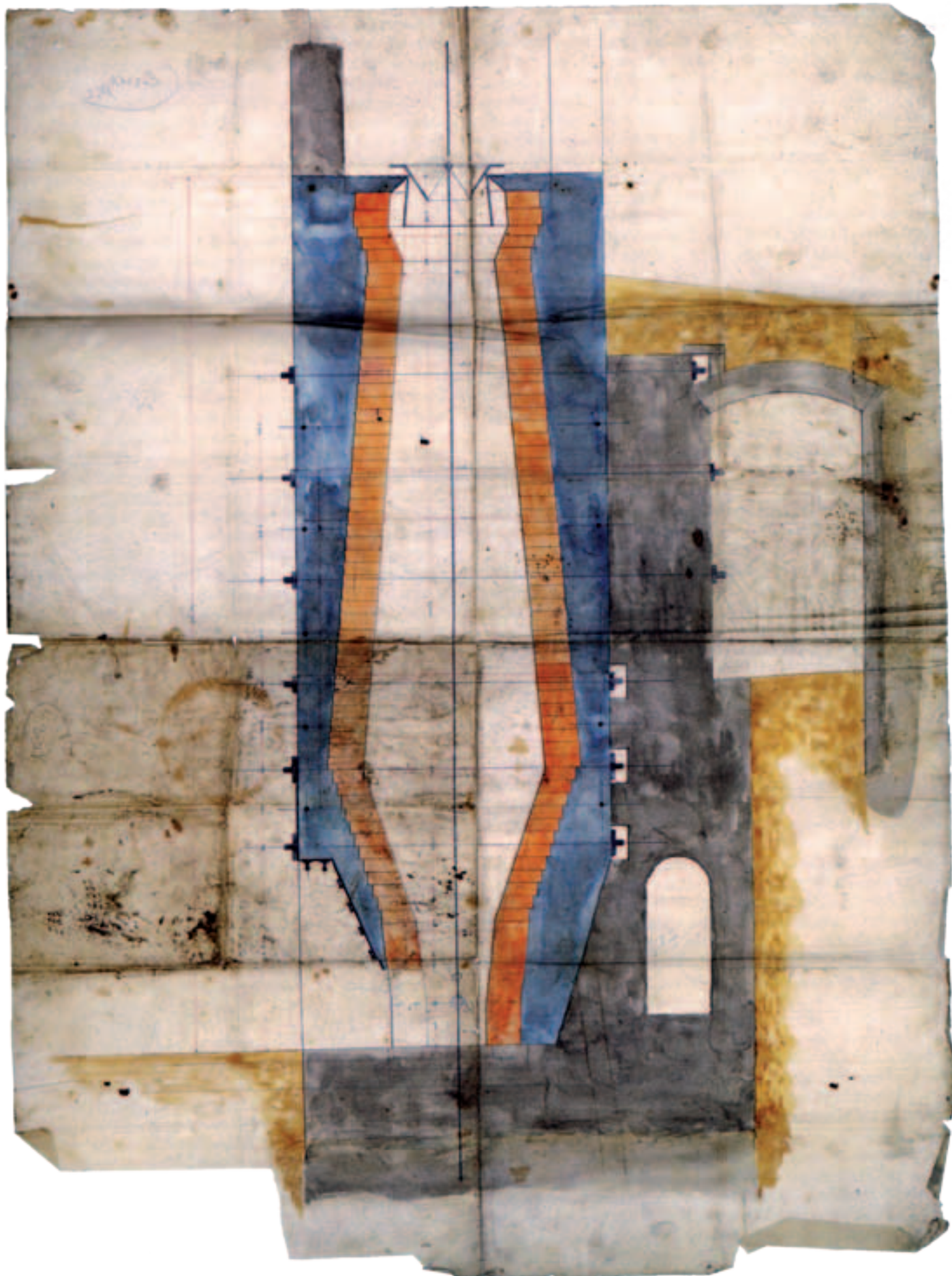
La sezione del forno di Govine, in La sorgente dei metalli , Breno (Bs) 2000, p. 144.
