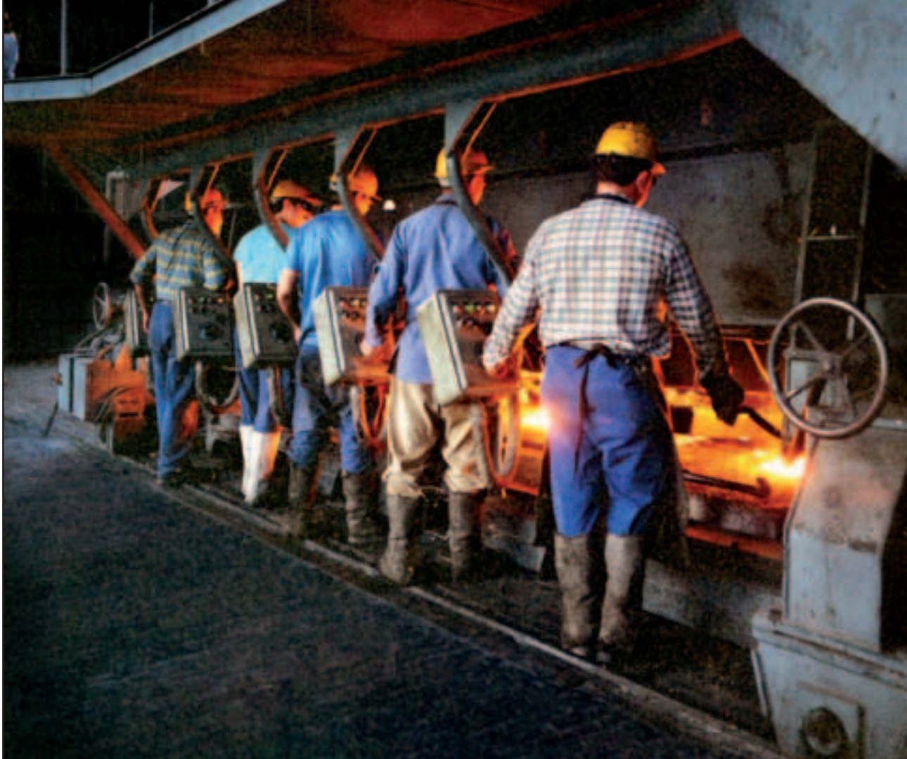
Operai addetti alla colata continua in un'acciaieria camuna.
